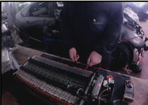
Prueba de celdas desconectas de batería de Toyota Prius
