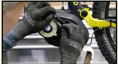
Desmontaje de motor eléctrico de bicicleta para su comprobación y mantenimiento
